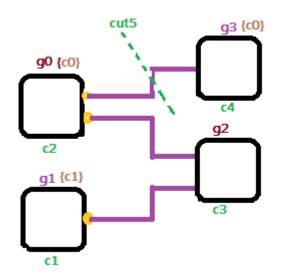
Figure 4 正确的 CLK 分割示意图
