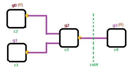
Figure 3 错误的 FFD 切割示意图
